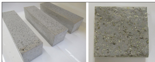
14. ábra: A zeolit felhasználásával készült keverék próbatestei
