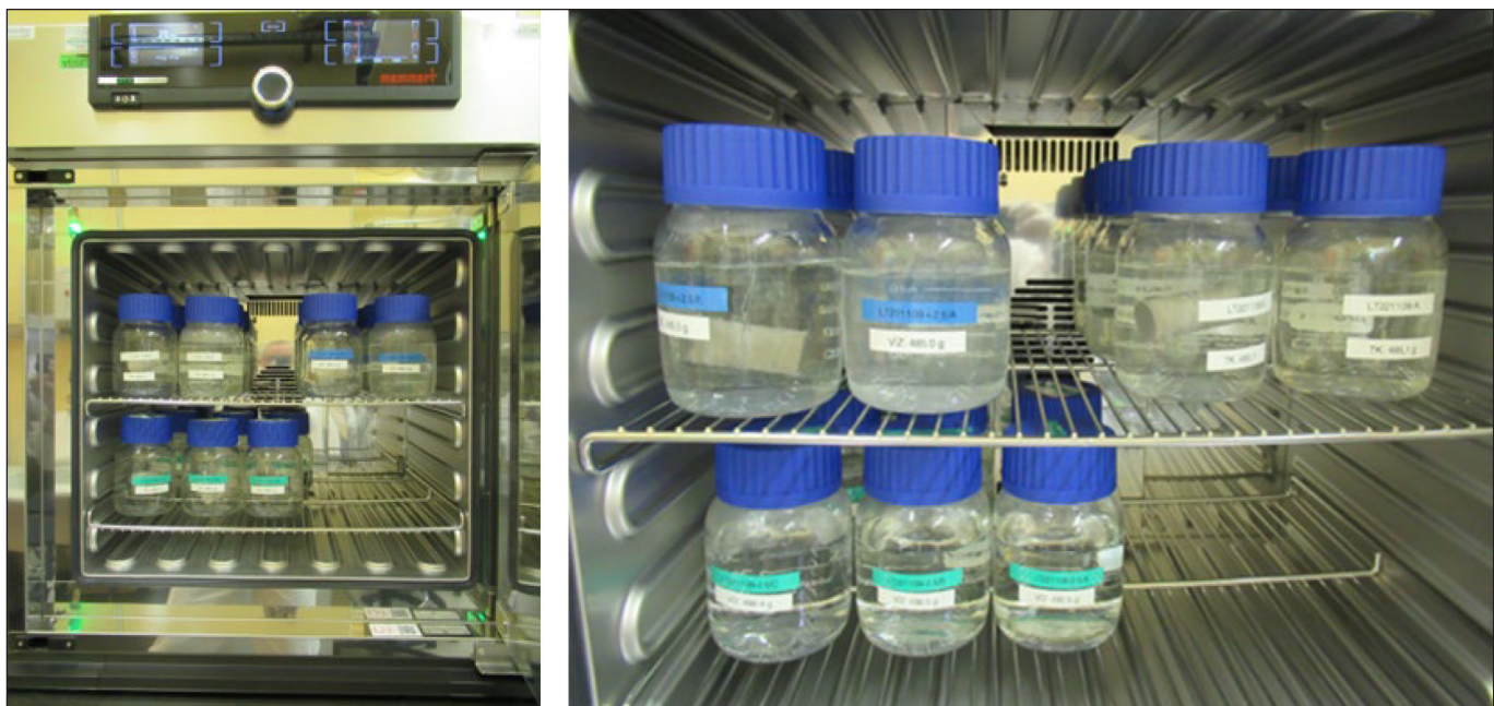
8. ábra: Kioldódás vizsgálat az ASTM C1308-08 szabvány alapján
